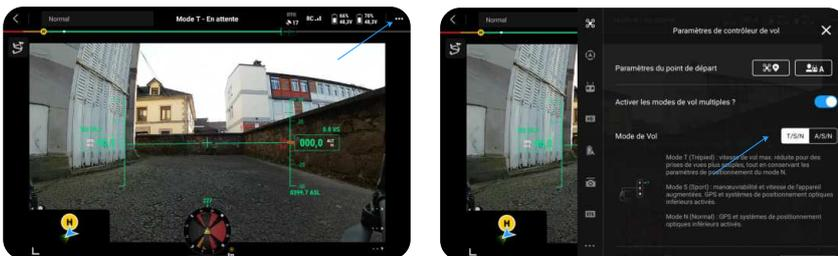
3 Basculez le sélecteur de mode de vol de la radiocommande DJI RC Plus, du mode N au mode F. Le mode F correspond au mode T.
