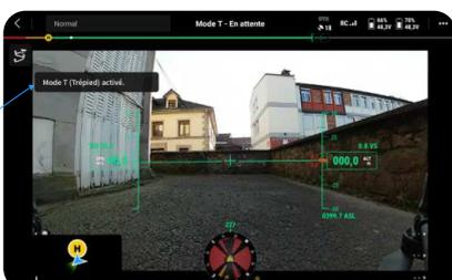
L'utilisation du mode S (Sport) est proscrite lorsque le kit conversion C5 installé sur le drone DJI Mavic 3. Tous les tests de validation du système Kronos MVC3 ont été effectués exclusivement en mode N (Normal), garantissant un comportement conforme aux exigences de sécurité.
