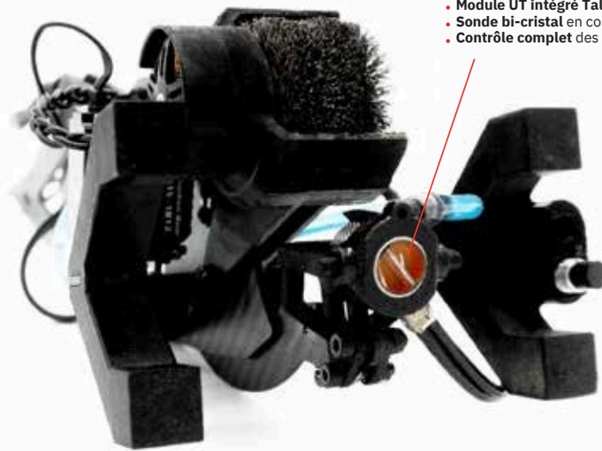
Sonde Thornetix à double cristal – haute précision et options de fréquences flexibles.
